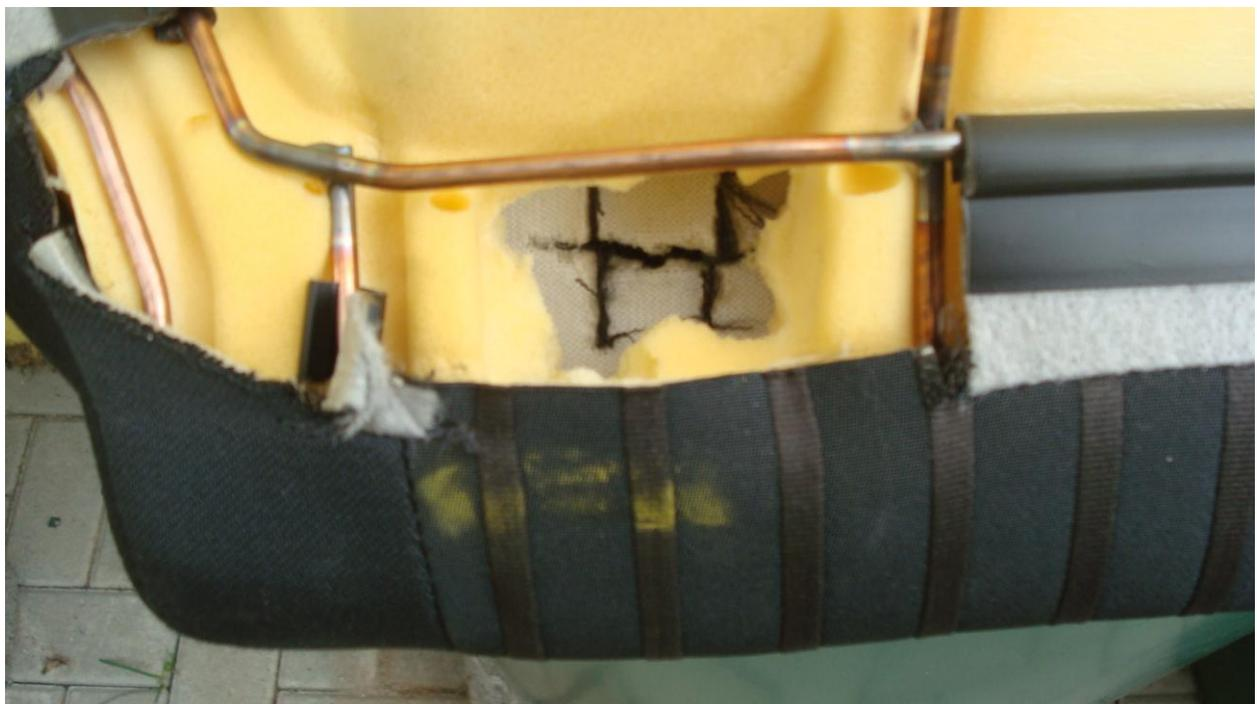
Bild N: H-Schnitt ca. zwischen gelber Mark. und Kupferbügel
