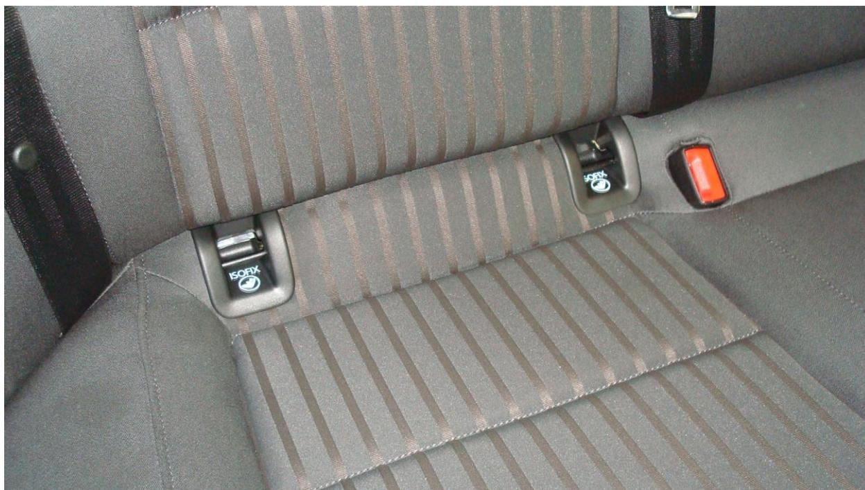
Bild T: sieht dann so aus. Drückt die Halterungen vom Isofix fest in ihre baulich festgelegte Situation. Kurz fest reinclipsen und etwas hochdrücken. Passt.
