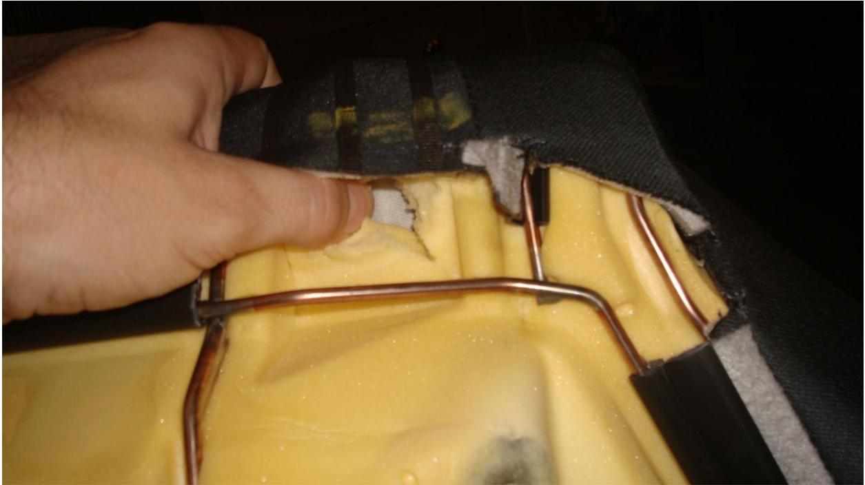
Bild I: Schneide das Polster kurz unter der gelben Marke und zwischen dem kupferfarbenen Bügel aus. (macht dies sauberer als ich)
