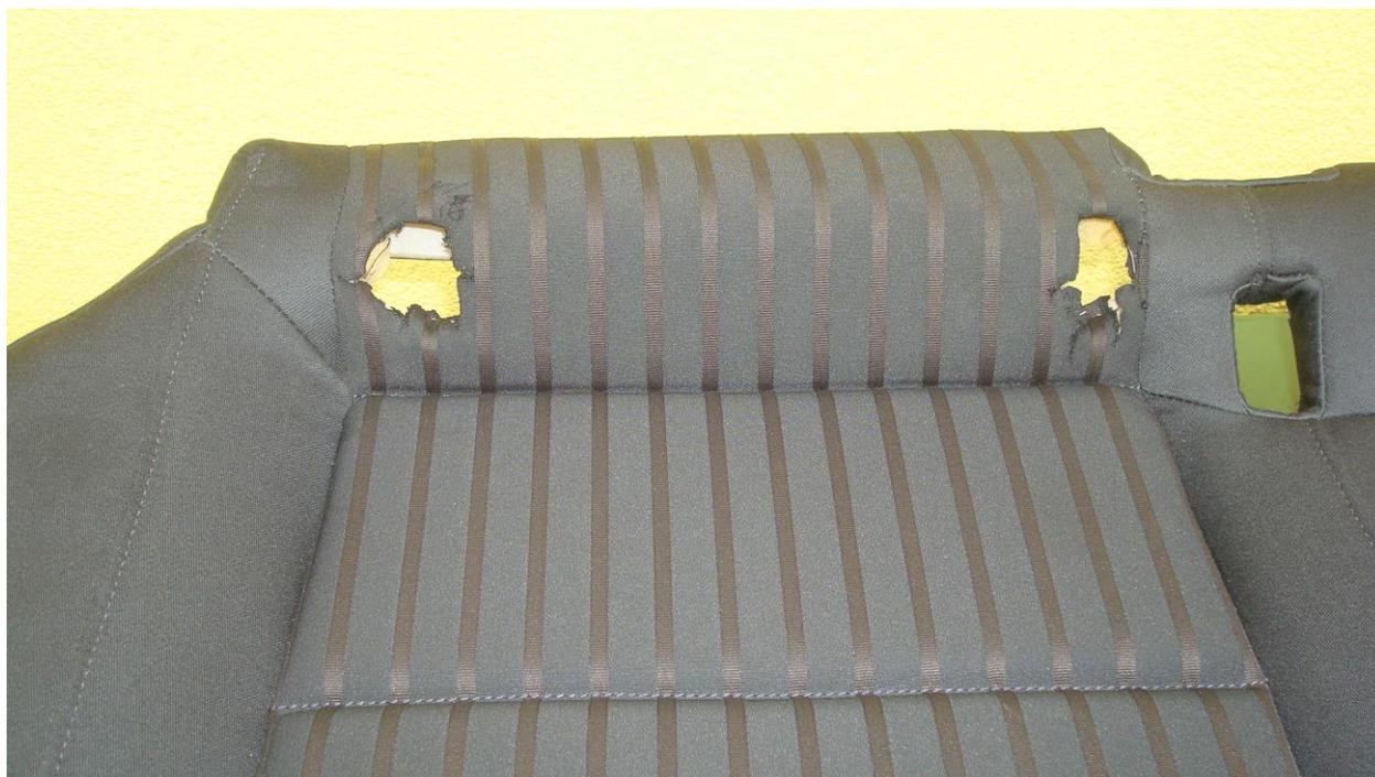
Bild S: Zeigt meine Höhe des Einschnittes und die Löcher im Polster. Macht nun mit Verdünnung den gelben Edding von den Bügeln und macht die zwei neuen weißen Clips von Audi rein. Befestigt die Sitzbank wieder.
