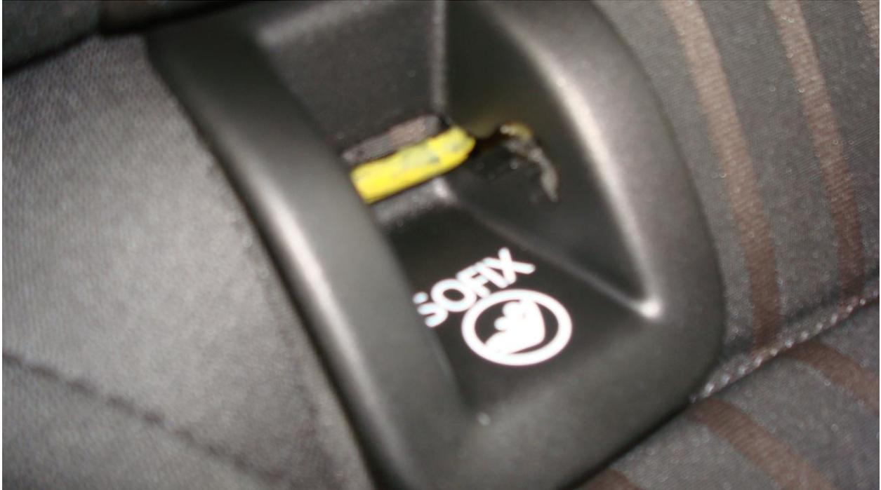
Bild O: Baut die Bank ein ohne wie üblich diese einzuklipsen und drückt mal die Iso-Halterung drauf. Ihr werdet merken ob noch Schaumstoff weg muß oder ob ihr noch den Stoff vom Polster weiter ausschneiden müsst. (Macht lieber zu Beginn einen weniger großen Schnitt ins Polster und arbeitet nach.
