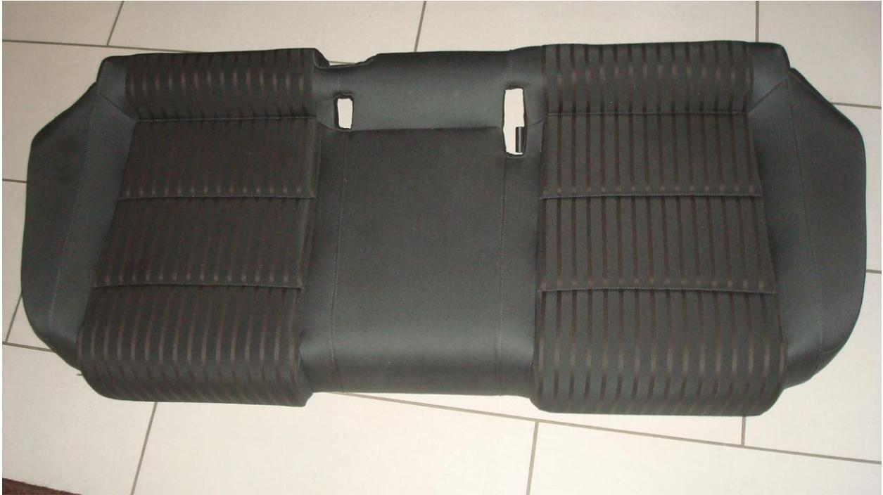
Bild A: greift das Rückbankpolster mit einer Hand ans Polster Türseitig und mit der anderen auf Höhe Mitte des Fahrersitzes und zieht mit einem Ruck. Das Ganze linke und rechte Seite machen und ihr habt die Sitzbank draußen. Weiße Clips siehe Bild B. (gehen gerne kaputt)
