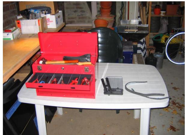
Dann benötigt ihr neben dem normalen Werkzeug, was man immer so liegen haben muss (also Steckschlüsselsatz, Kreuz- und Längsschlitzschraubendreher, verschiedene Zangen usw.) noch einen **Drehmomentschlüssel**, den ihr auf 40 nM einstellen könnt, um das Lenkrad aus- und einbauen zu können, sowie Sicherungslack für die Schrauben des Lenkrads und eventuell noch einen Lötkolben, falls ihr eine Kabelverbindung durchtrennen müsst, die der Vorbesitzer um einen Träger herum...☺&Ⓜ%§\*\$...
