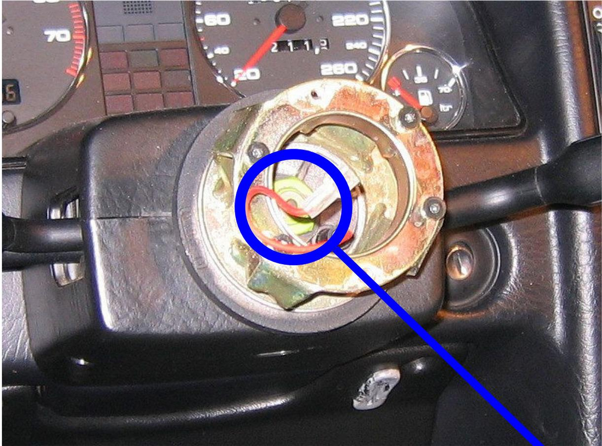
Was ihr da vor euch habt, ist der gesamte Umbau der Lenkradnabe mit der **Sicherungsmutter** (die ist original gelb markiert und hier mit dem blauen Kreis markiert). Diese Mutter muss nun gelöst werden - hier das Resultat der Aktion:
