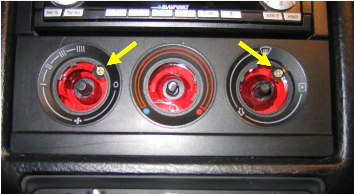
Nach dem Lösen der oben gelb markierten Schrauben könnt ihr die Frontplatte der Einheit nach vorn abziehen (eventuell mit einem Spatel oder einem Messer seitlich abhebeln). Das muss dann so aussehen:
